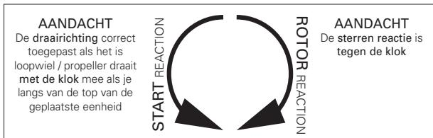
Bij grote pompen is de draairichting ook te herkennen door via de persaansluiting in de pompkamer te kijken. Hier is de waaier te zien en kan de draairichting worden gecontroleerd na kort inschakelen, bij het uitlopen van de waaier.
