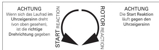
Bei großen Pumpen kann man die Drehrichtung auch erkennen, indem man durch den Druckstutzen in die Pumpenkammer schaut. Hier sieht man das Laufrad und kann nach einem kurzen einschalten, beim auslaufen des Laufrades die Drehrichtung kontrollieren.
